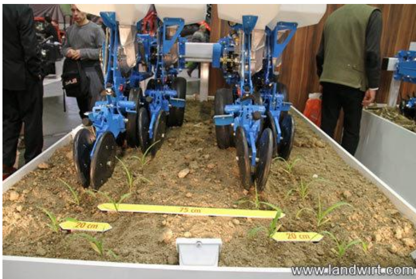
Obrázek 13 Setí do dvojřádků od firmy Monosem
