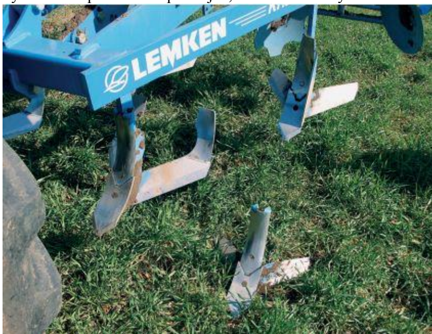
Obrázek 7 Na přední řadě radličky TriMix a na druhé DuoMix
