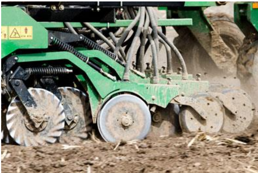
Obrázek 11 Uspořádání pracovních nástrojů stroje Spartan 607
