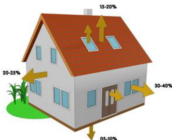
Obrázek č. 1: Celkový únik tepla z domu (převzato z [1])
