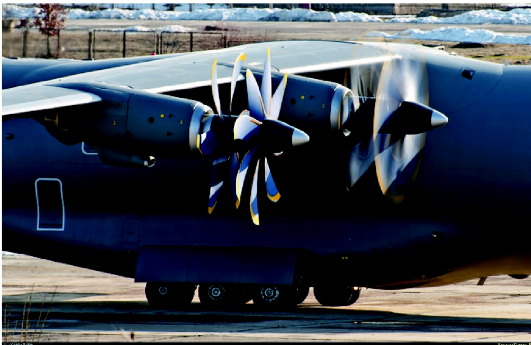
Obr. 18 Ruský vojenský letoun An-70 osazený motory propfan s protiběžnými vrtulami [15]
