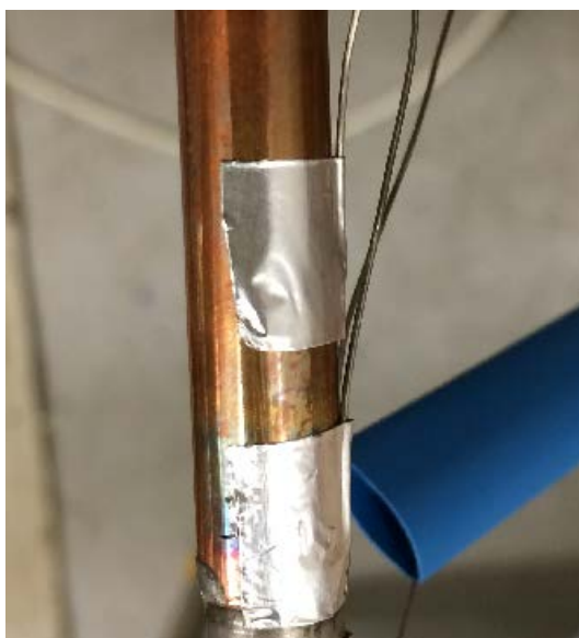
Obr. 26 Připevnění termočlánků k povrchu makety
