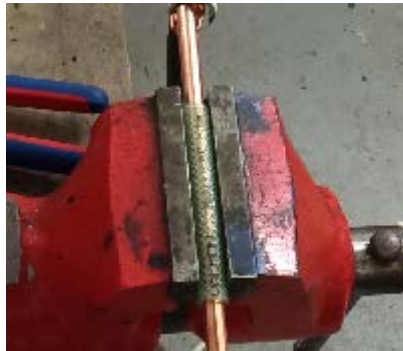
Obr. 28 Elektrická izolace makety
