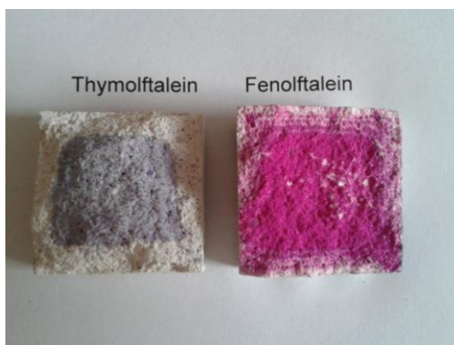
Obr. 7 Zkouška karbonatace na vzorcích slabě zkarbonatované vápenné malty pomocí acidobazických indikátorů
