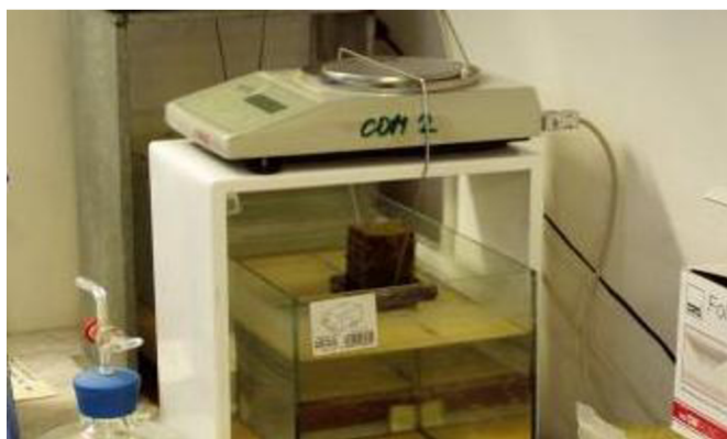
Obr. 13 Aparatura pro stanovení průměrného součinitele vlhkostní vodivosti
