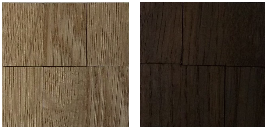
Obr. 21 - Ukázka barevné změny tepelně modifikovaného dubu, podmínky jsou popsané v kapitole 5.2 (foto Hasenkopf)
