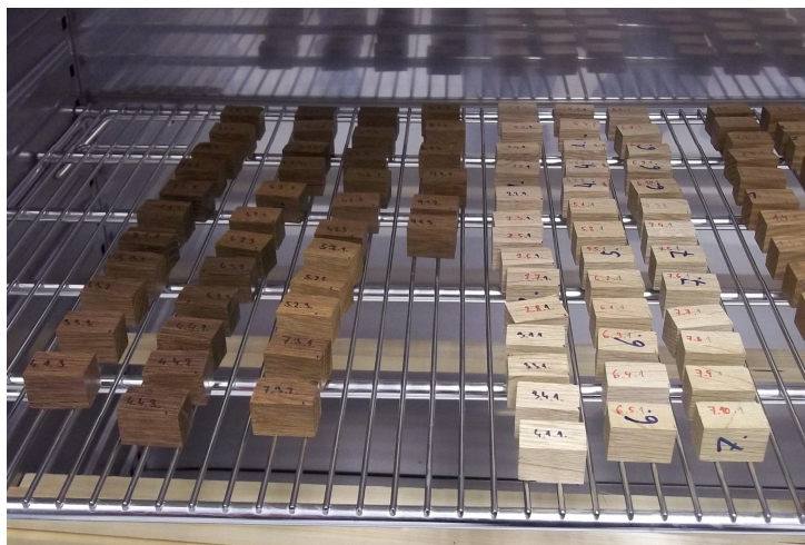
Obr. 26 - Uložení vzorků v klimatizační komoře (foto Hasenkopf)
