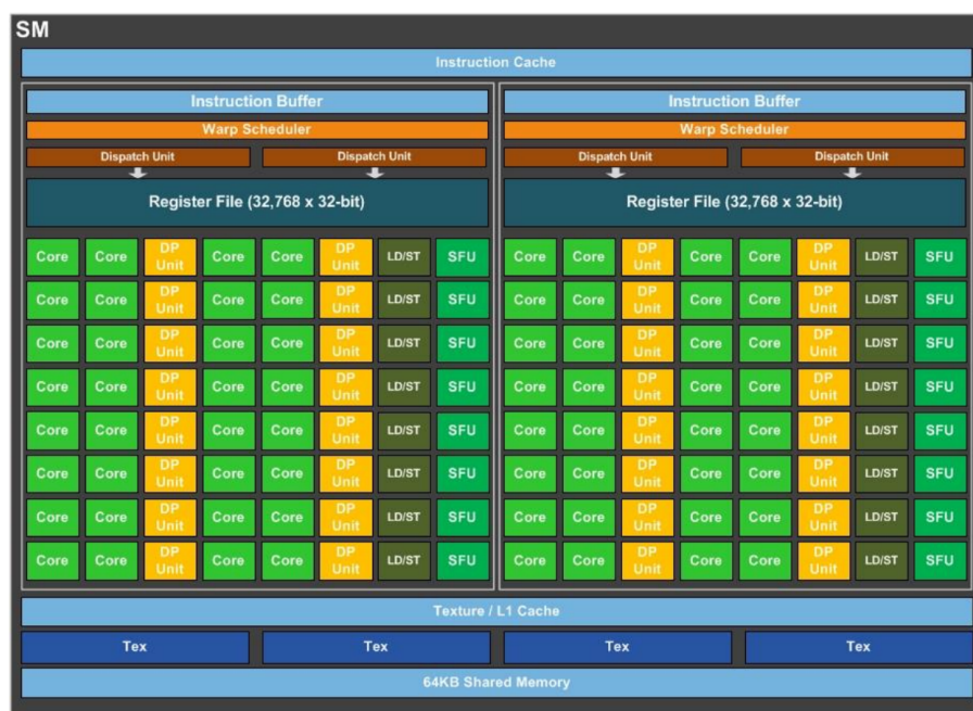
Obrázek 3.1: Schéma stream multiprocessoru. Každý multiprocessor obsahuje množství výpočetních jednotek, velké množství (řádově desetitisíce) registrů, texturovací jednotky, vyrovnávací paměť cache, sdílenou paměť a také plánovací logiku. Převzato z webu 2 .
