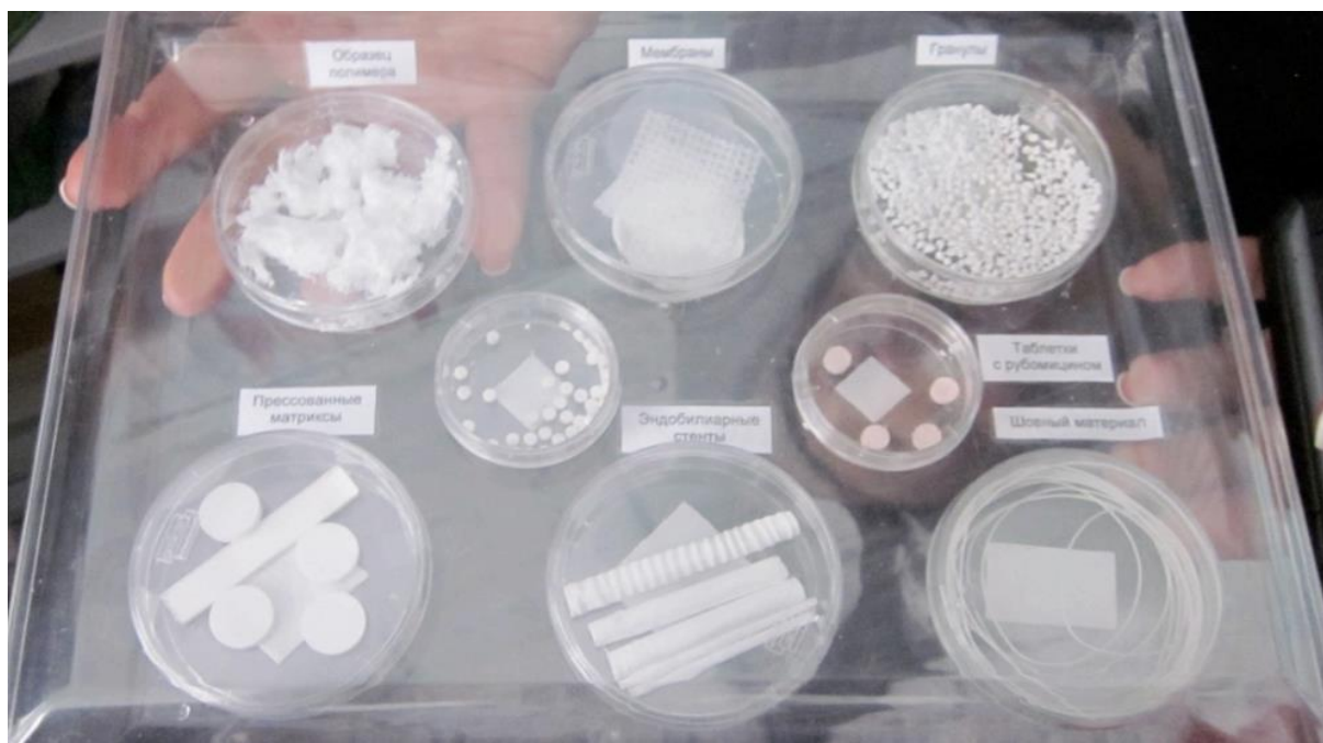
Образок 6: Приклады spracovania PHA matric pre nosičové systémy [52]
