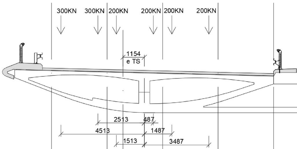
Model LM3 3000/420 bol umiestnený do stredu mostovky a ostatná prevádzka na moste bola zakázaná. Model LM3 1800/200 bol umiestnený na mostovku podľa normy.
