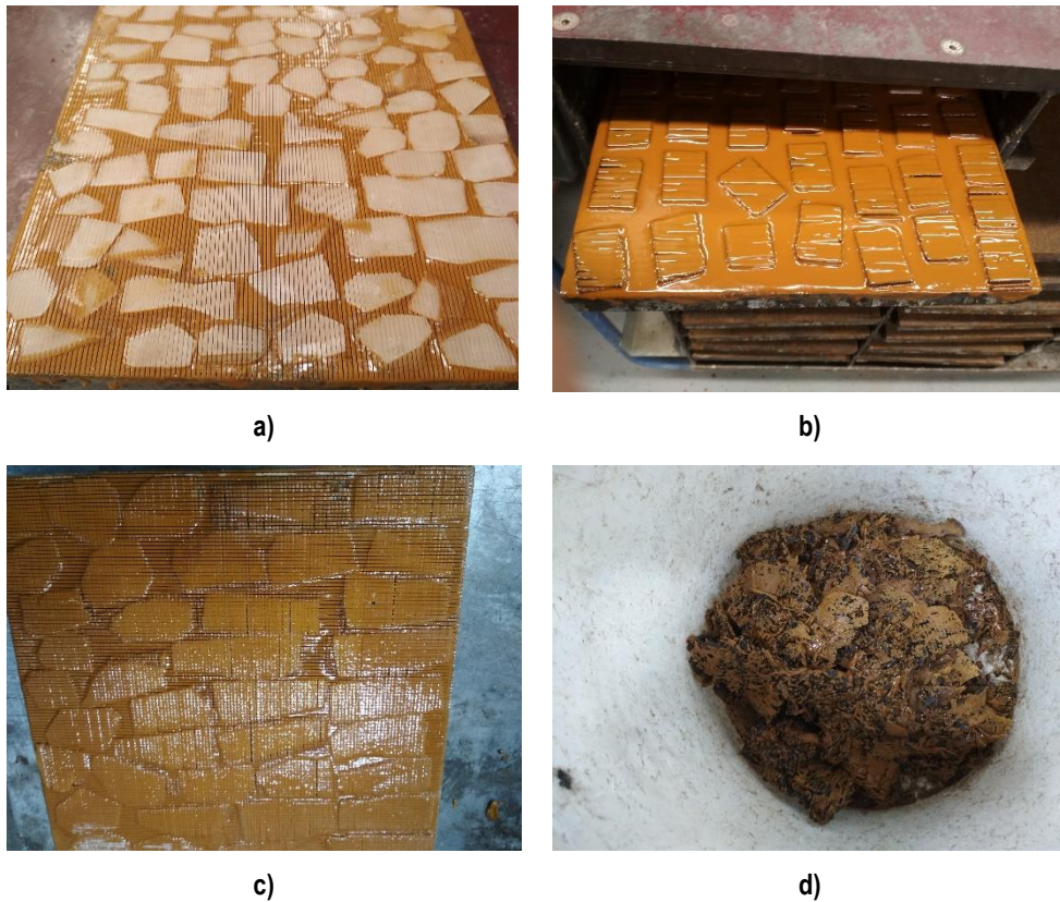
Obr. 6-56: Dělení kubické zirkonie 2. a) plátky nařezané na proužky; b) mezioperační přetmelení; c) plátky nařezané na kostičky; d) odtmelené kostičky před mytím.
