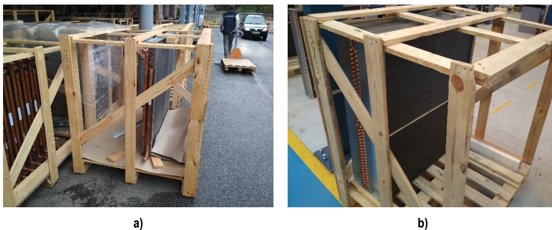
Obr. 6-27: Ukázky bednění a zbývajících výměníků: a) bednění ve skladu výměníků; b) bednění u výrobní linky.
