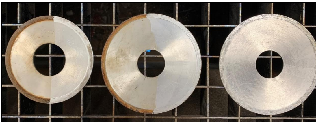
Obr. 6-64: Test čištění kroužků pomocí čistícího laseru.
