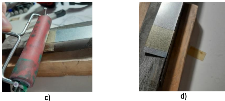
Obr. 6-76: Prvotní „proof of concept“ ověření námětu: a) umístění čepele; b) přiložení folie s plechem; c) přitlačení válečkem; d) odříznutý okraj.
