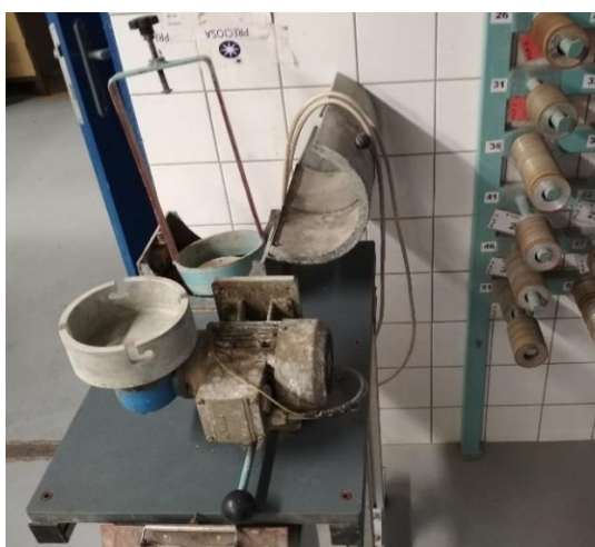
Obr. 6-63: Přípravek na obrušování distančních kroužků.
