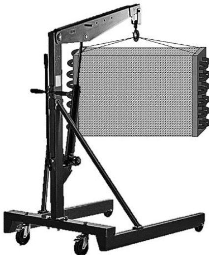
Obr. 6-28: Schématické zobrazení použití dílenského jeřábu na přepravu výměníků.
