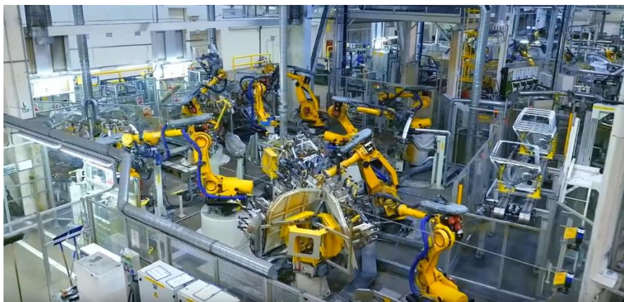
Obr. 6-51: Ukázka robotického pracoviště pro lepení dílů na svařovně. [280]
