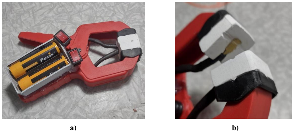
Obr. 6-81: Druhý zkušební koncept navržených kleští: a) celé kleště; b) detail svařovací části.
