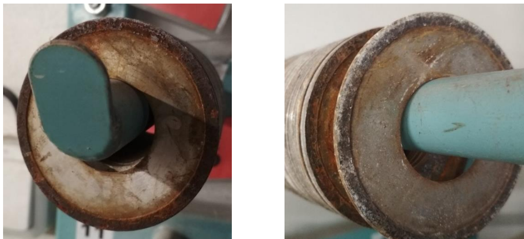
Obr. 6-62: Příkladů distančních kroužků s nánosem sedimentů.
