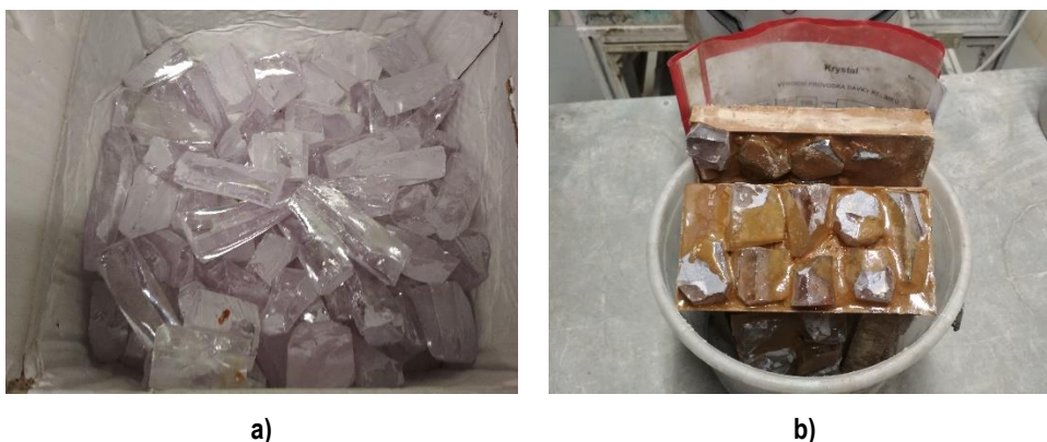
Obr. 6-55: Dělení kubické zirkonie 1. a) vstupní materiál; b) zatmelené krystaly.
