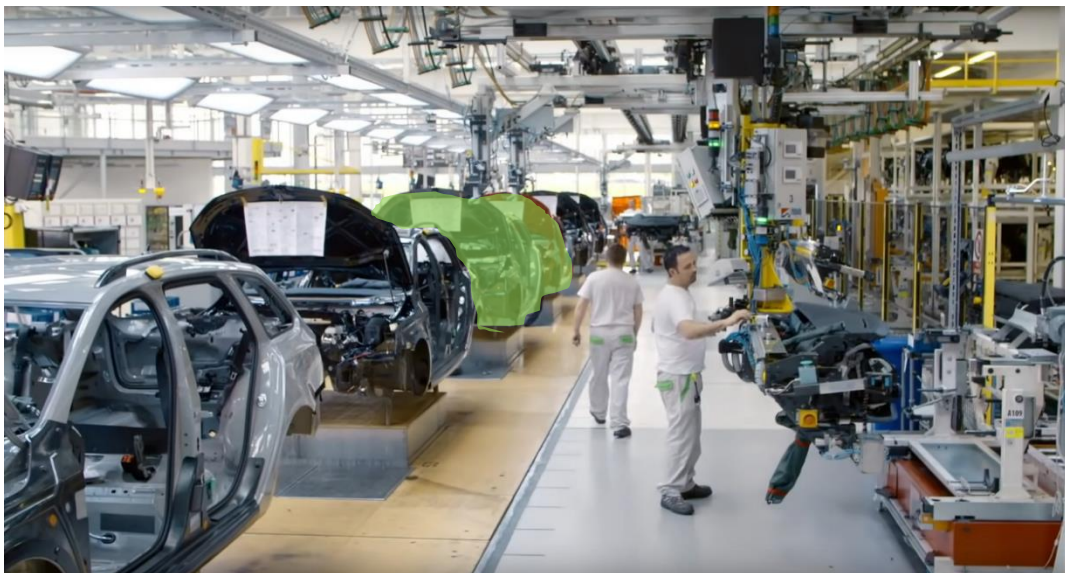
Obr. 6-48: Stanoviště pro montáž tažného zařízení (zeleně) mezi stanovišti pro vkládání modulů palubních desek. [280] (upraveno)
