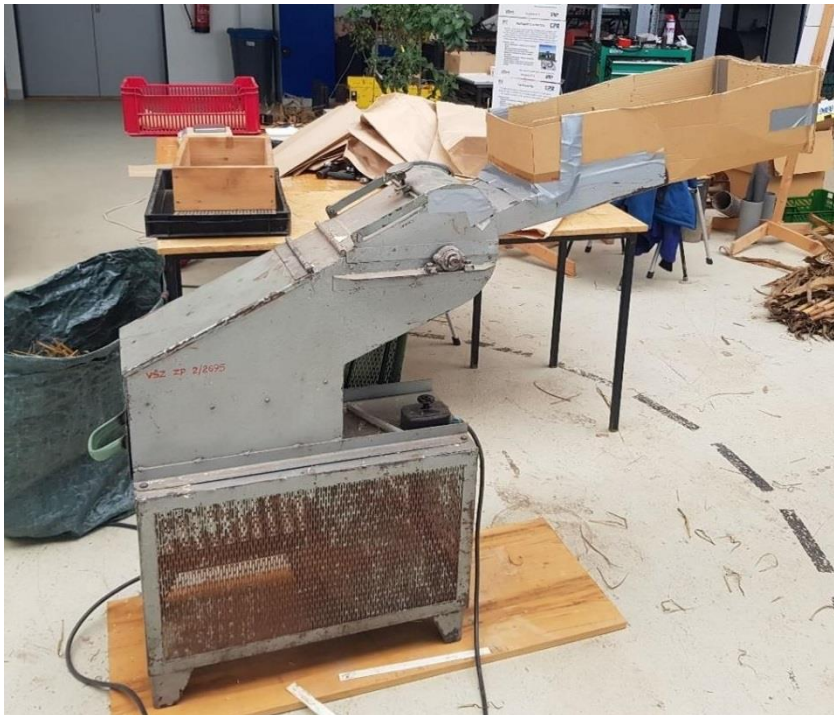
Obr. 5: Stacionární mlátička (foto Bureš)
