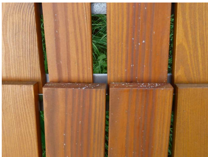
Obrázek 2: Září - na modřínových vzorcích se objevují výrony pryskyřice (zdroj: vlastní)
