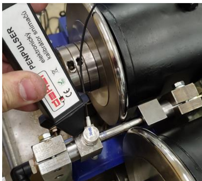
Obr. 5-7 Měření amplitudy pulzu
