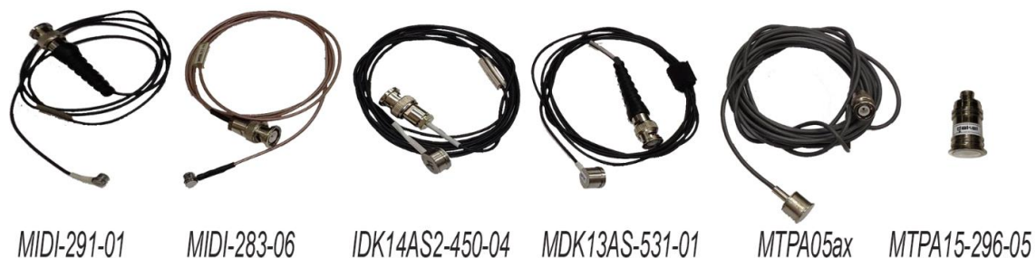
Obr. 5-6 Testované snímače AE (zleva číslo 1 až 6)
