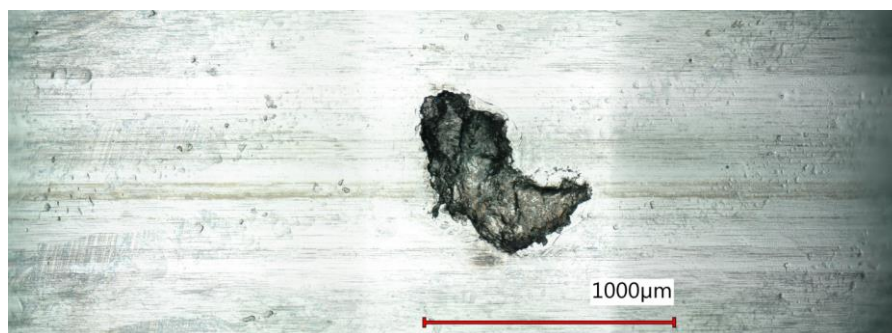
Obr. 5-20 Pitting na zkušebním vzorku
