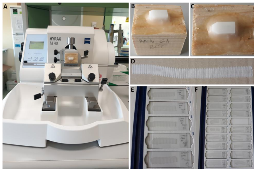
Obr 4: Příprava a řezání vzorků na mikrotomu. Dřevěný bloček s voskovým blokem v držáku mikrotomu (A), dřevěné bločky s voskovými bloky (B, C), páska jednotlivých řezů (D), podložní sklíčka s voskovými řezy (E, F).
