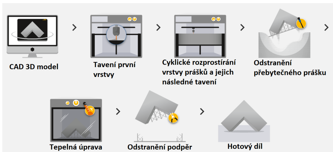
Obr 2.6 Schéma postupu tisku metodou SLM [18]
