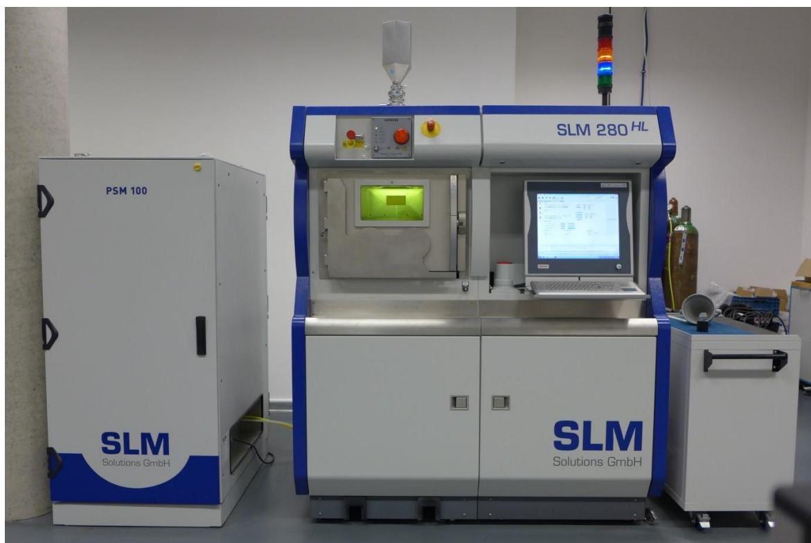
Obr. 3.1 3D tiskárna SLM280HL (SLM Solution Group AG, Lübeck, Německo)
