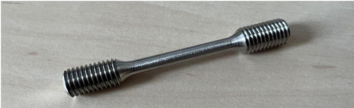
Obr. 3.13 Zkušební vzorky pro statickou zkoušku tahem
