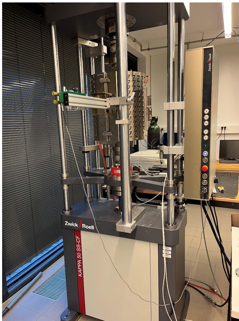
Obr. 3.14 Zkušební stroj Zwick Roell KAPPA 50 SS-CF
