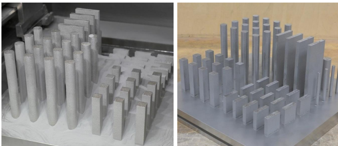
Obr. 3.4 Proces odsávání přebytečného prášku
