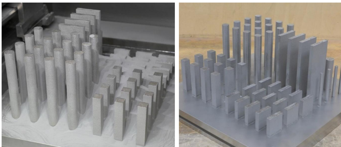
Obr. 3.4 Proces odsávání přebytečného prášku
