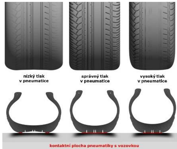
Obrázek 5 - Stopa pneumatiky v závislosti na huštění pneumatik [4]
