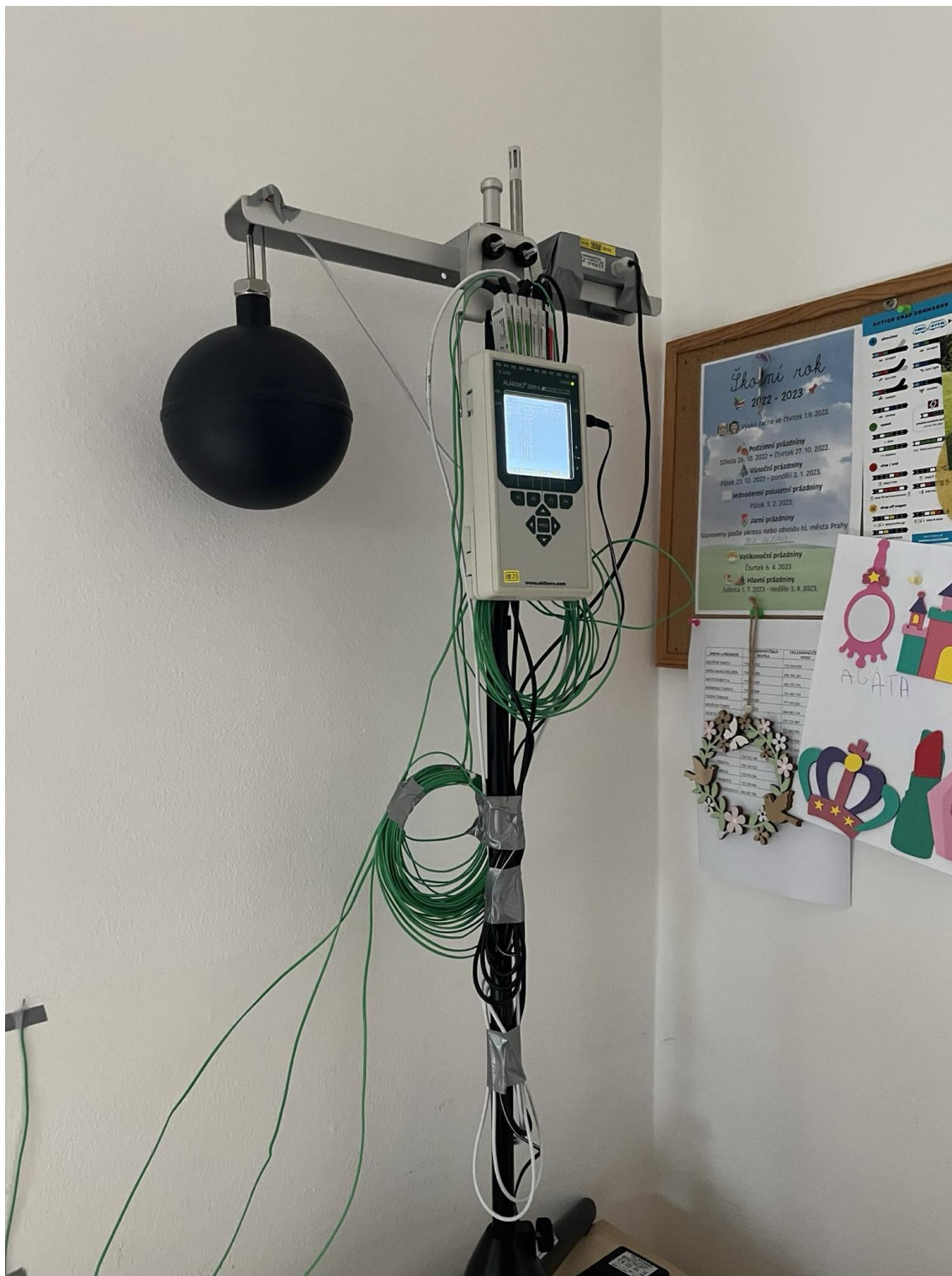
Obr. 29.: Instalace měřících čidel – stativ s ústřednou, kulovým teploměrem, snimačem CO 2 a kombinovaným čidlem teploty, vlhkosti vzduchu, rosného bodu a atmosférického tlaku
