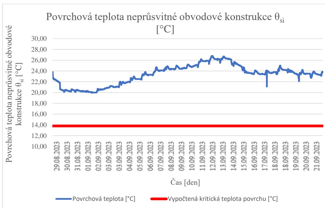
Graf 34.: Průběh povrchové teploty v porovnání s vypočtenou kritickou povrchovou teplotou
