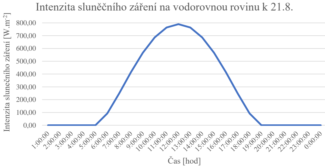
Graf 02.: Normový průběh intenzity slunečního záření na vodorovnou rovinu k 21.8. dle ČSN 73 0540-3 – Tepelná ochrana budov – Část 3: Návrhové hodnoty veličin [48]
