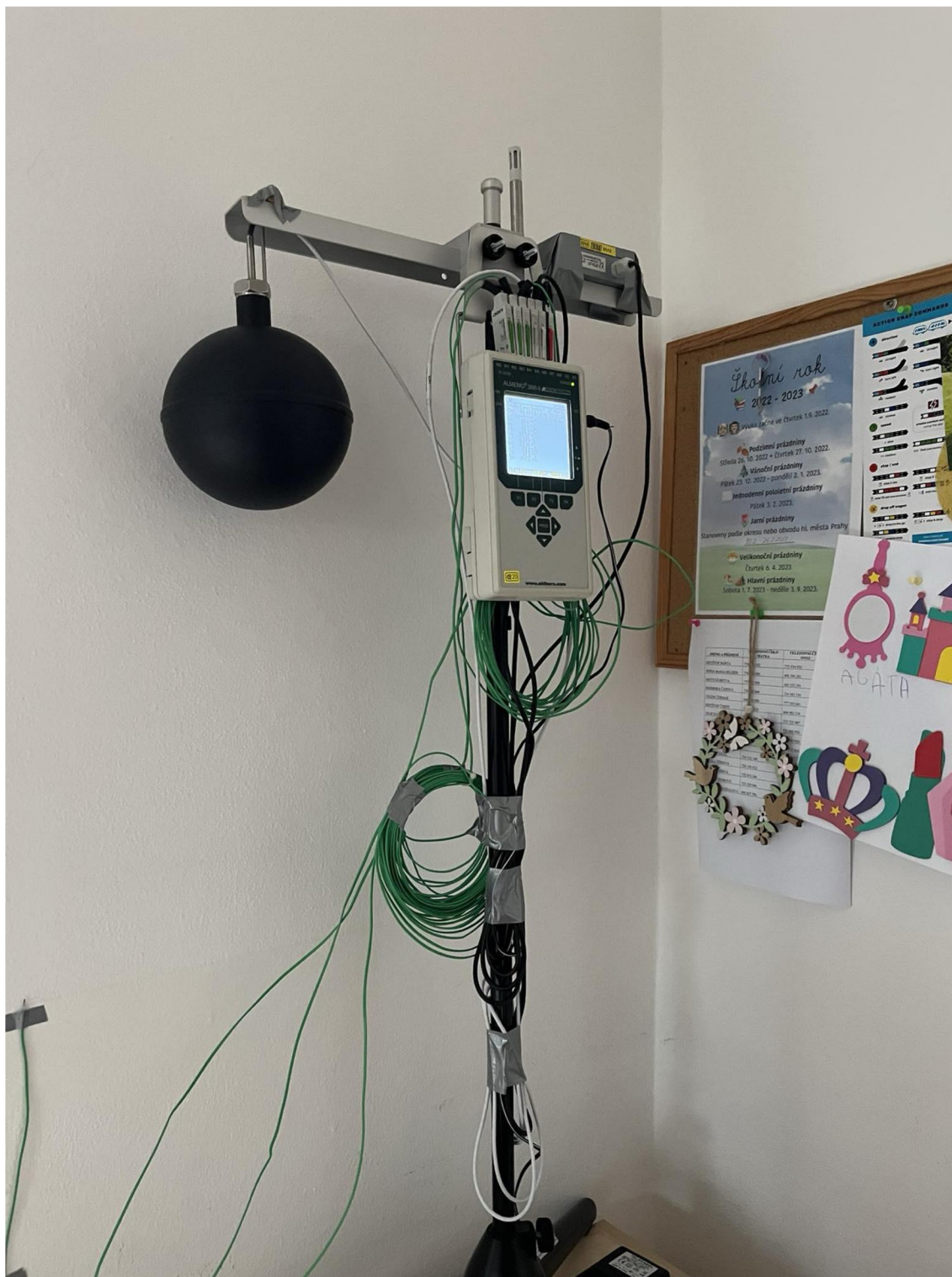
Obr. 29.: Instalace měřicích čidel – stativ s ústřednou, kulovým teploměrem, snimačem CO 2 a kombinovaným čidlem teploty, vlhkosti vzduchu, rosného bodu a atmosférického tlaku
