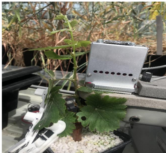
Obrázek 3: Měření pomocí přístroje LCpro + (zdroj: autor práce)
