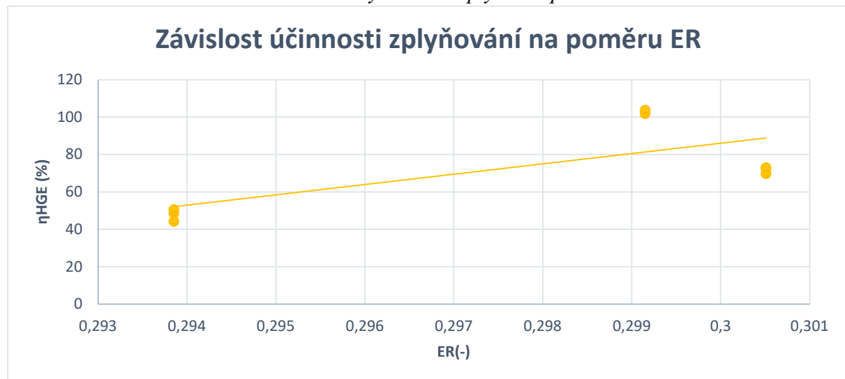
Obr.35 Závislost účinnosti zplyňování na poměru ER
