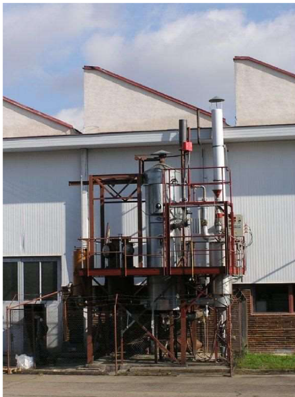
Obr.15 Experimentální zplyňovací jednotka Biofluid 2 [24]
