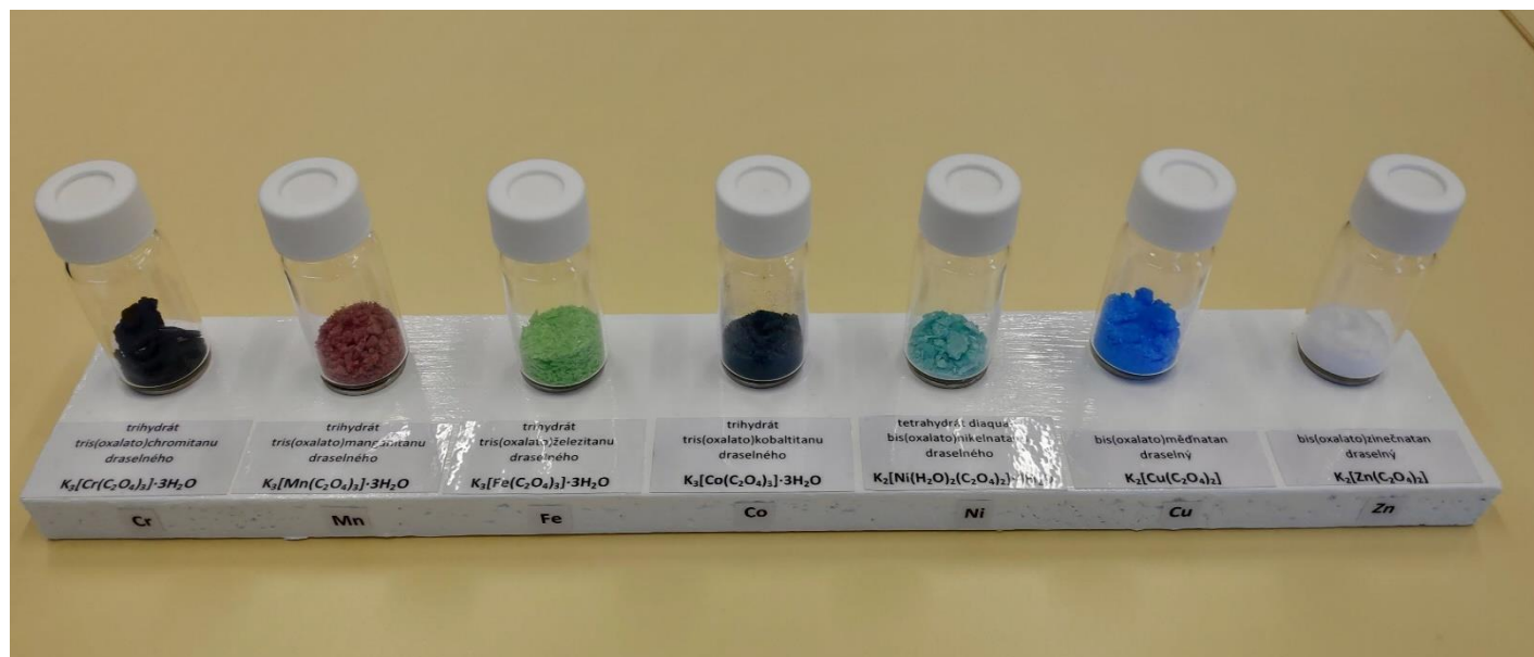
Obr. 32: Sběrka oxalatokomplexů s přechodnými kovy 4. periody (Cr III , Mn III , Fe III , Co III , Ni II , Cu II , Zn II )
