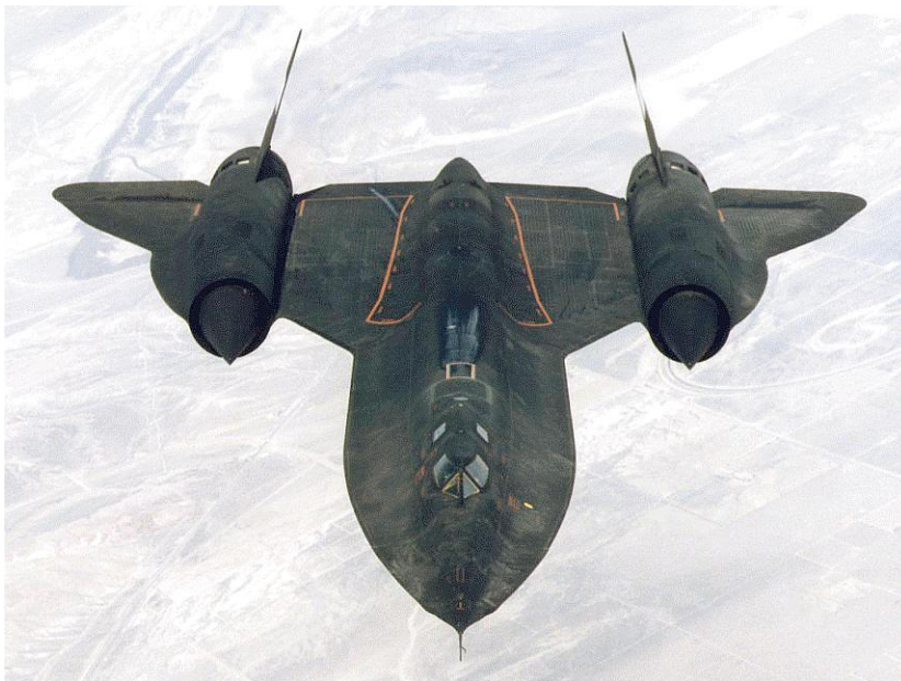
Obr. 2.4. Prakticky celotitanová konstrukce letounu SR-71 Blackbird [17]
