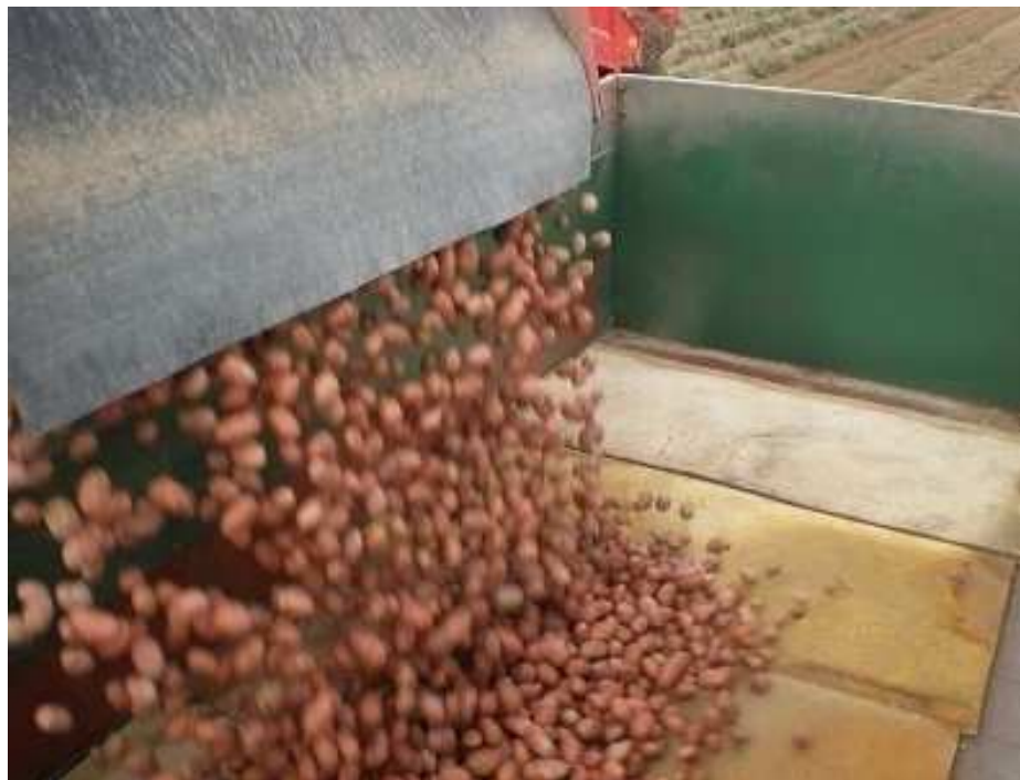
Obrázek 29 Odběr hlíz při dopadu na molitanovou matraci [15]
