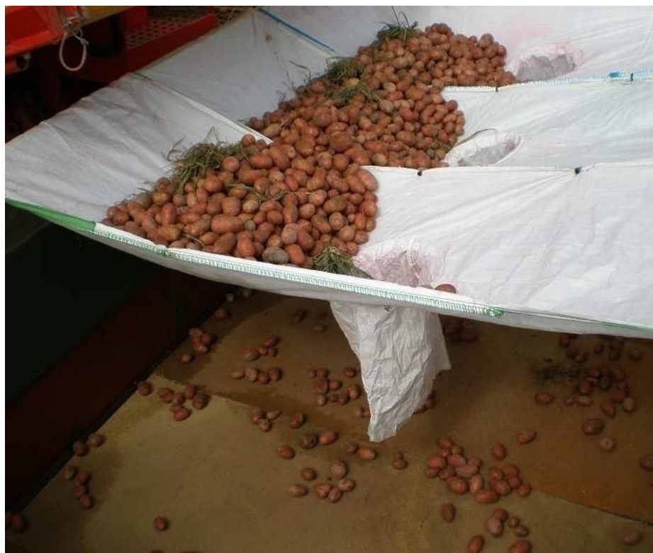
Obrázek 30 Odběr hlíz při dopadu do záchytné sítě a na molitanovou matraci [15]
