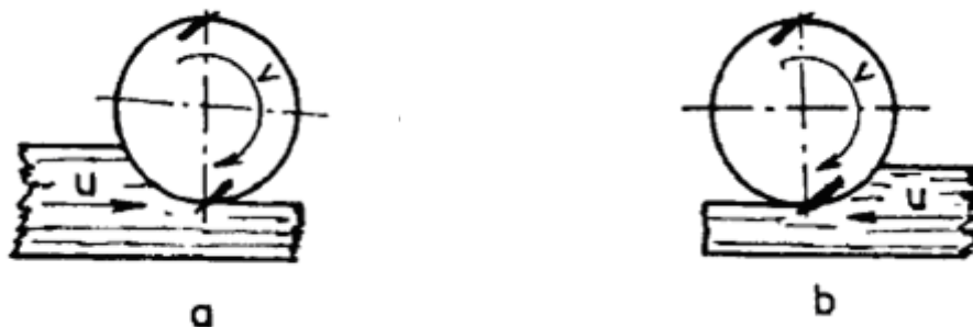
Obr. 18 Kinematické varianty frézování a) protiběžné; b) souběžné (Lisičan, 2007)
