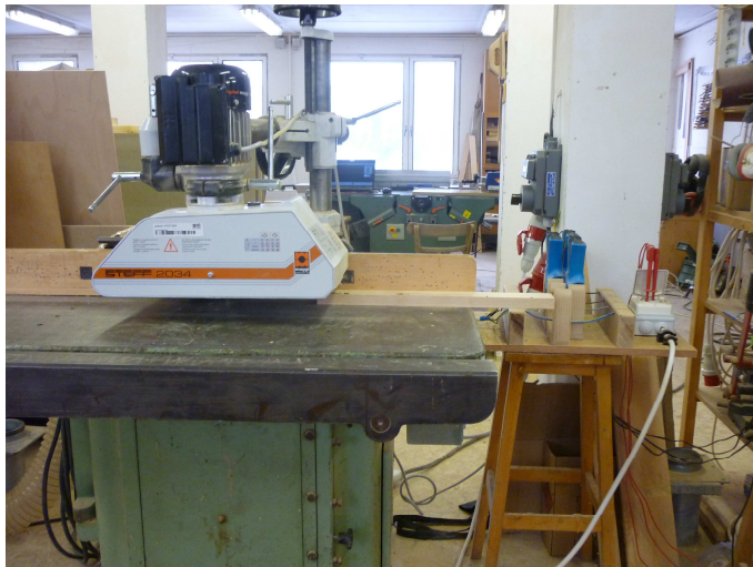
Obr. 31 Spodní jednovřetenová frézka s podávacím zařízením (autor)
