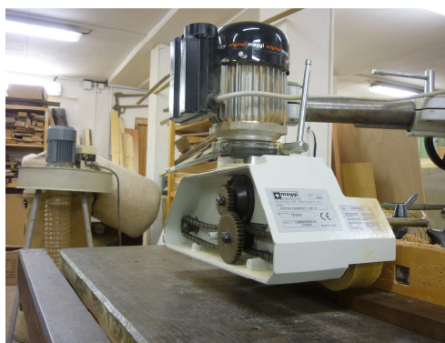
Obr. 32 Podávácí zařízení STEFF 2034 (autor)
