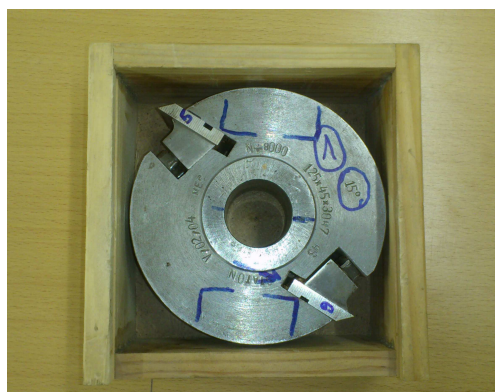
Obr. 33 Frézovací hlava s úhlem čela 15^\circ pro experimentální měření (autor)
