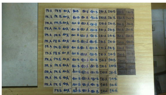
Obr. 35 Stanovení hustoty – experimentální vzorky (autor)
