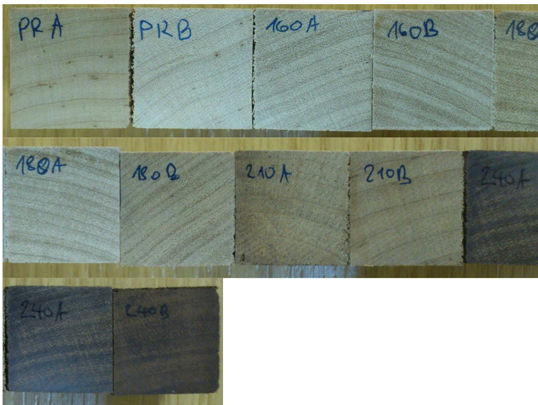
Obr. 40 Vyrazný rozdíl v struktuře dřeva jednotlivých typů tepelné úpravy zkoumaného materiálu (autor)
