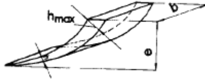
Obr. 23 Profil třísky odřezané válcovou frézou (Lisičan, 2007)
