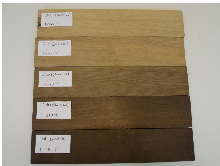
Obr. 6 Barevný rozdíl rostlého (nahore) a tepelně upraveného dubového dřeva ( Quercus ) a změny barvy při teplotě od 160°C do 240°C (autor)
