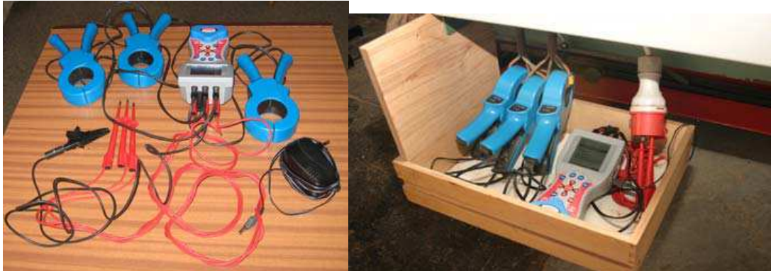
Obr. 28 Měřicí zařízení Metrel Power Q Plus MI 2392 a jeho zapojení (Siklienka, Argay, 2012)
