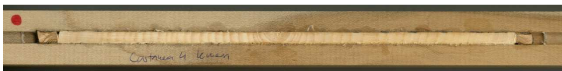
Obr. 8 – Ukázka kmenového vývrtu odebraného z kaštanovníku jedlého ( Castanea sativa MILL.) zařezaného do dřevěné liště.
