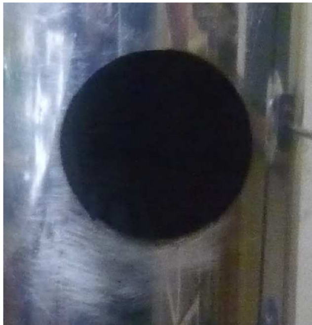
Obr. 11-1 Zaměřovací terčík d = 60 mm
