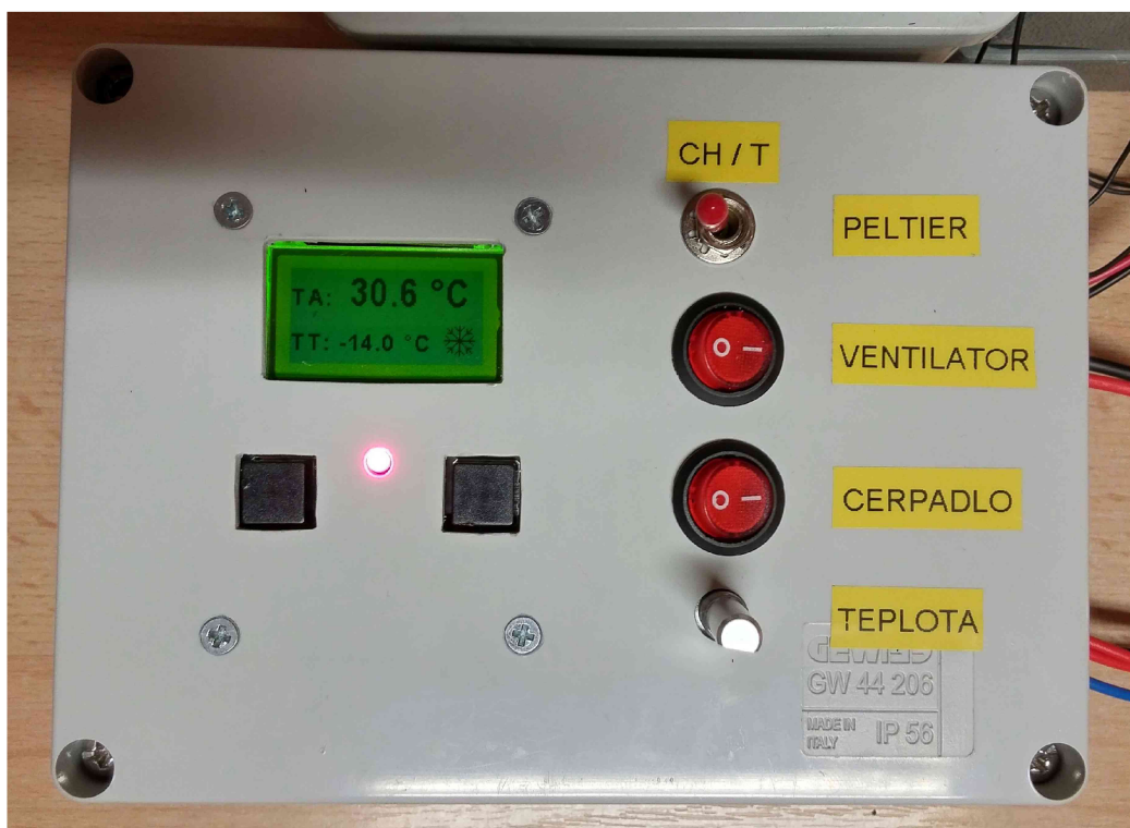
Obr. 5.3: Displej pro Peltierův kontrolér s tlačítky a potenciometrem
