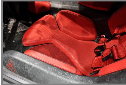
Obr. 4-2 Vzhľad kovaného kompozitu v modeli Sesto Elemento [23]
