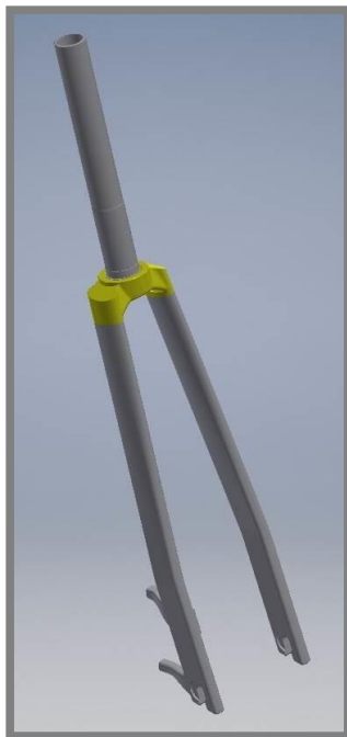
Obr. 1-1 Zvýraznená korunka na vidlici od firmy Favorit
