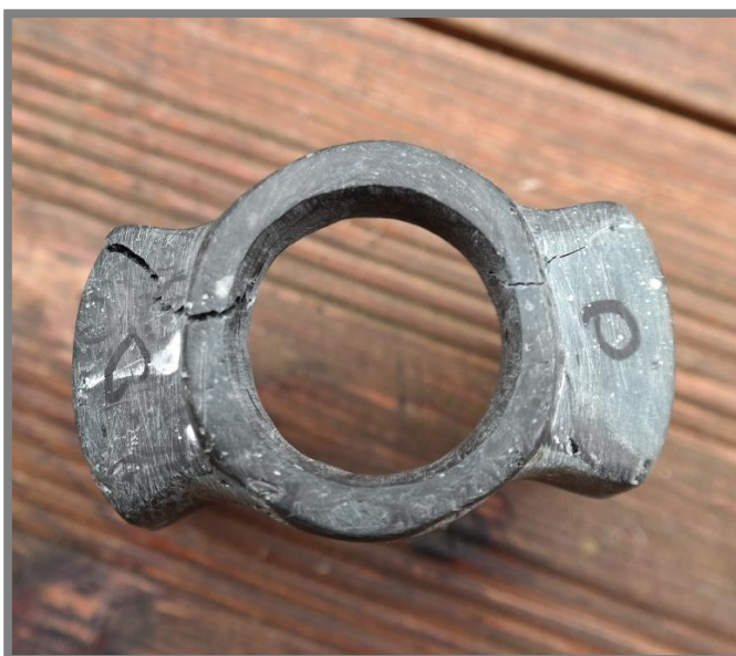
Obr. 5-20 Zlomený 0. prototyp zo sadrovej formy (9 Kg)
