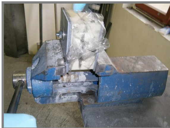
Obr. 5-12 Lisovanie pomocou zveráku
