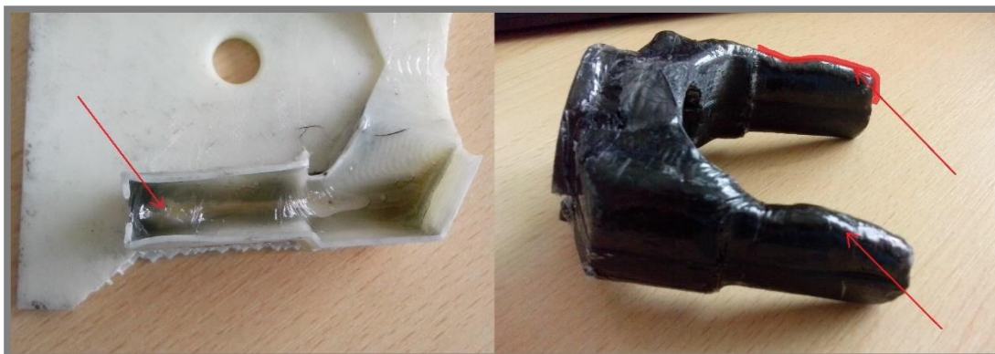
Obr. 6-2 Defekt spôsobený strečovou fóliou
