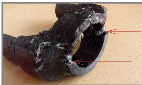
Obr. 6-1 Defekt spôsobený vymývaním vlákna
