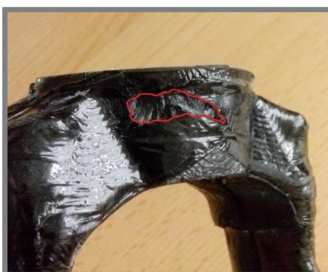
Obr. 6-3 Defekt spôsobený nahromadením strečovej fólie
