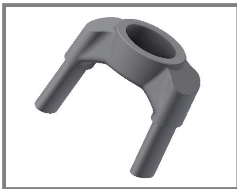
Obr. 4-1 Model hliníkovej korunky
