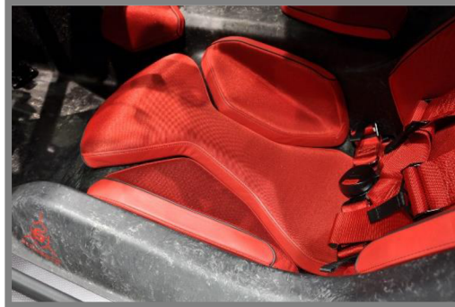
Obr. 4-2 Vzhľad kovaného kompozitu v modeli Sesto Elemento [23]
