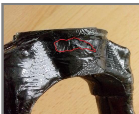
Obr. 6-3 Defekt spôsobený nahromadením strečovej fólie
