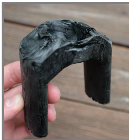
Obr. 50-7 Prvý pokus korunky z formy č. 2
