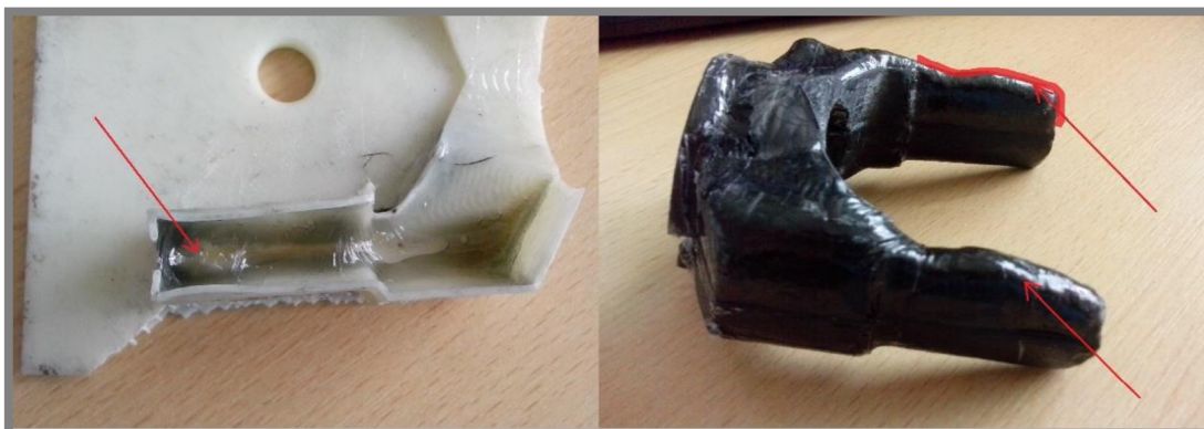
Obr. 6-2 Defekt spôsobený strečovou fóliou
