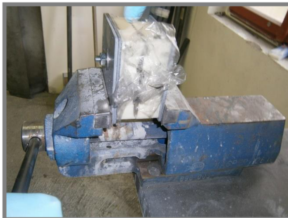
Obr. 5-12 Lisovanie pomocou zveráku
