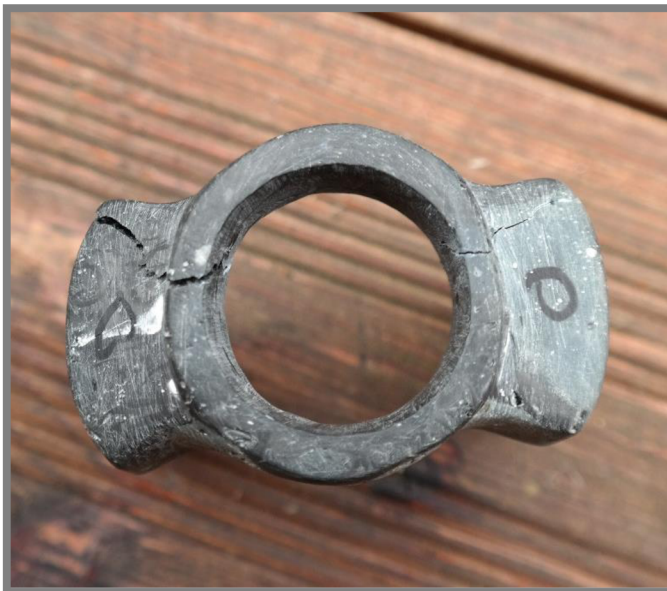
Obr. 5-20 Zlomený 0. prototyp zo sadrovej formy (9 Kg)
