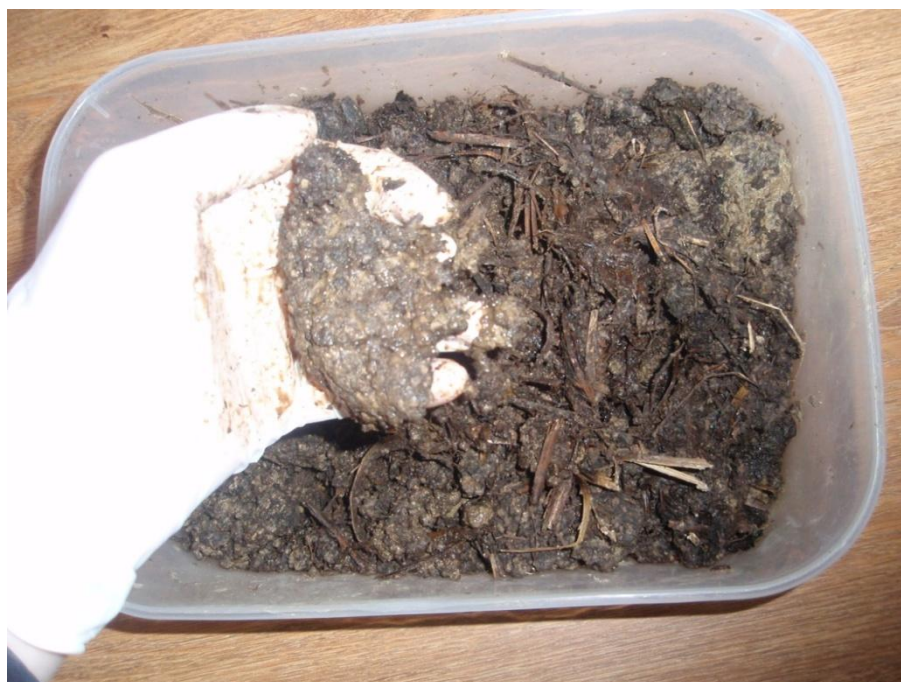
Obrázek č. 18: Měření vlhkosti
