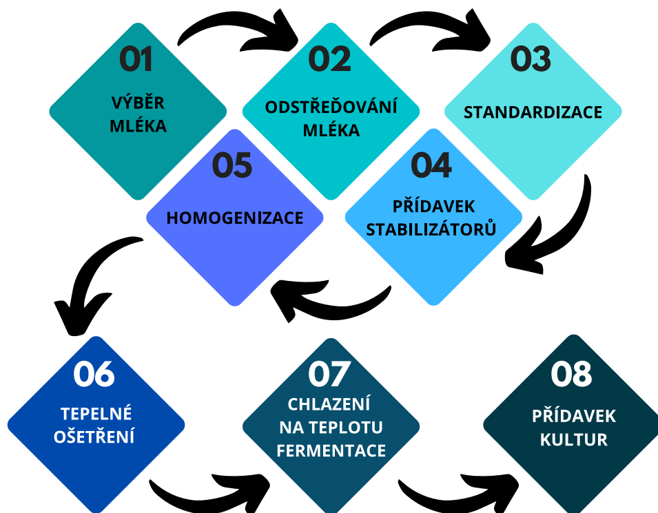
Obrázek č. 2: Úvodní kroky zpracování mléka pro výrobu FMV (zdroj: Šnirc et al. 2016, upraveno autorem)
