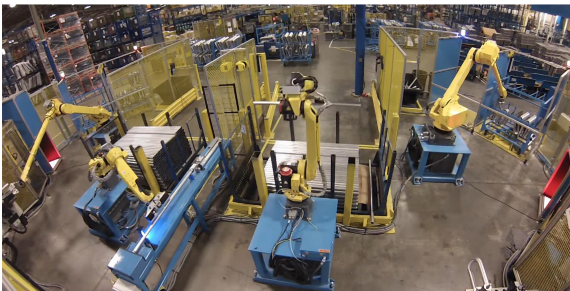
Obr. 5 Plně automatizovaná výrobní buňka pro ohýbání trubek [5]
