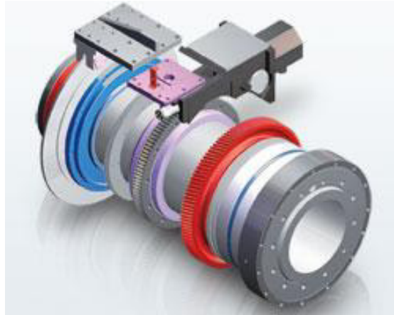
Obr. 2.32) Pohon C-osy šnekovým převodem [30]
