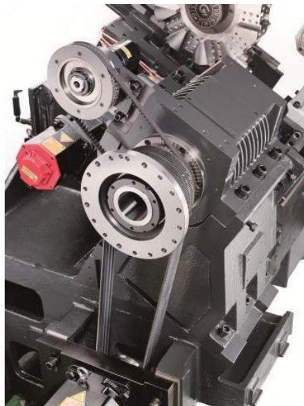
Obr. 2.33) Náhon C-osy řemenovým převodem [46]
