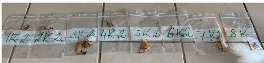
Obrázek 15: Odebrané vzorky kontrolních membrán (kationtová i aniontová) (autor fotografie: Daridová Petra)
