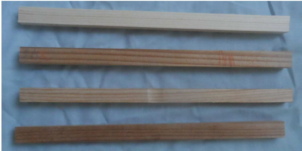
Obr. 12: Ukázka vzorků smrku, modifikovaného smrku, modřínu a modifikovaného modřínu (jemonované shora) po ohybové zkoušce tlakem.
