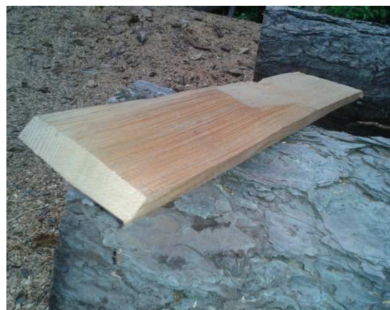
Obr. 5: Modřínový štípaný šindel alpský typ Výchozím materiálem pro výrobu štípaného modřínového šindele alpského typu je kulatina o minimálním průměru průřezu 30 cm bez kůry. Délka kulatiny nehraje ve výrobě významnou roli, protože je
