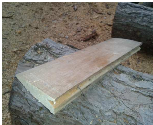
Obr. 6: Smrkový štípaný šindel valašský typ
