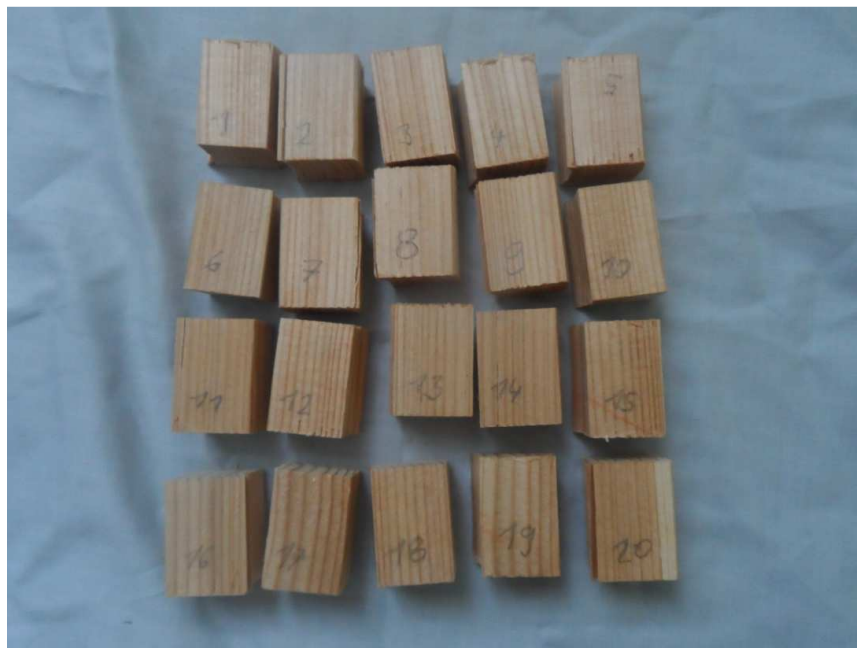
Obr. 18: Ukázka vzorků ze souboru modřínového dřeva po tlakové zkoušce v tangenciálním směru na vlákna.
