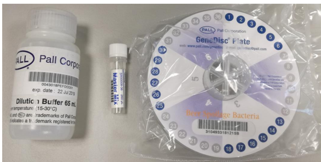
Obrázek 9 Vlevo ředící roztok, uprostřed směs Master Mix a vpravo plotna pro pivo kazící bakterie
