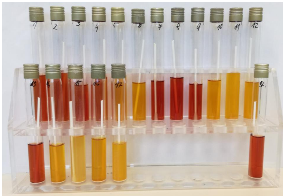
Obrázek 8 Pozitivní změna (žlutá barva) negativní změna (hnědočervená), slepý vzorek (vpravo dole)
