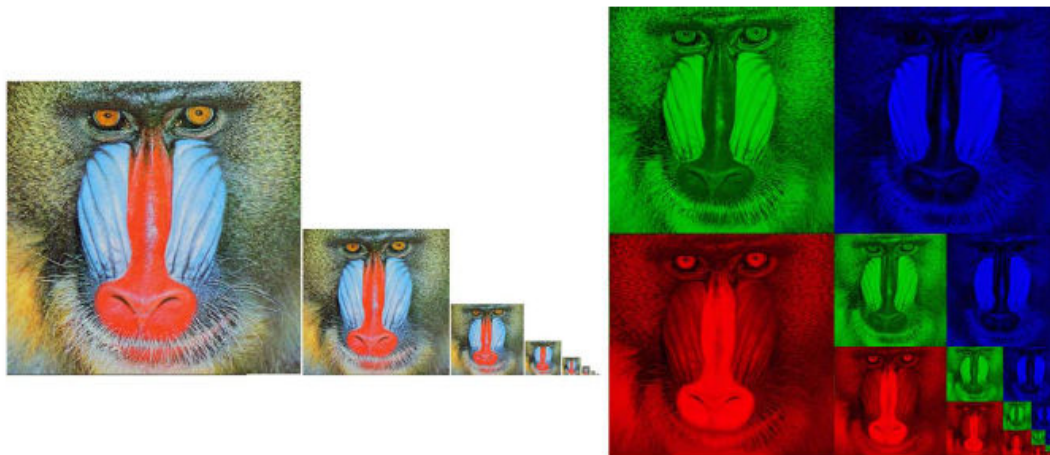
Obrázek 2-8: Ukázka MIP mapy (vlevo) a možné uložení v paměti (vpravo). Převzato z [10].
