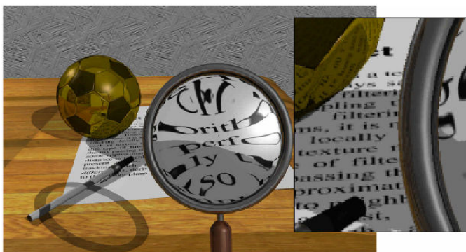
Obrázek 2-2: Ukázka mapování textur v ray tracingu. Převzato z [12].
