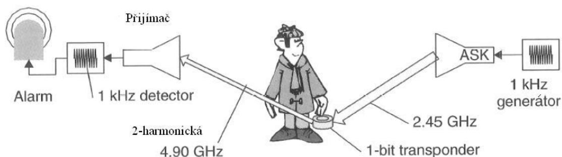
Obr. 1.8 – Princip mikrovlnného RFID tagu [6]
