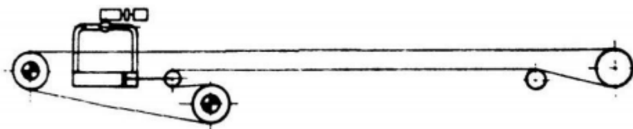
Obr. 31 Schéma elektrohydraulického napínání [1]
