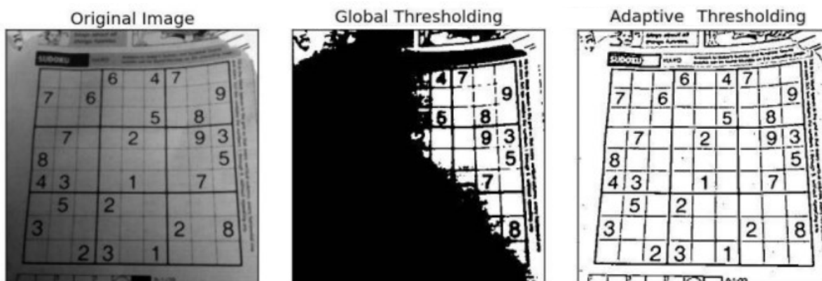
Obrázek 2.2: Efekt globálního a adaptivního prahování[14]
