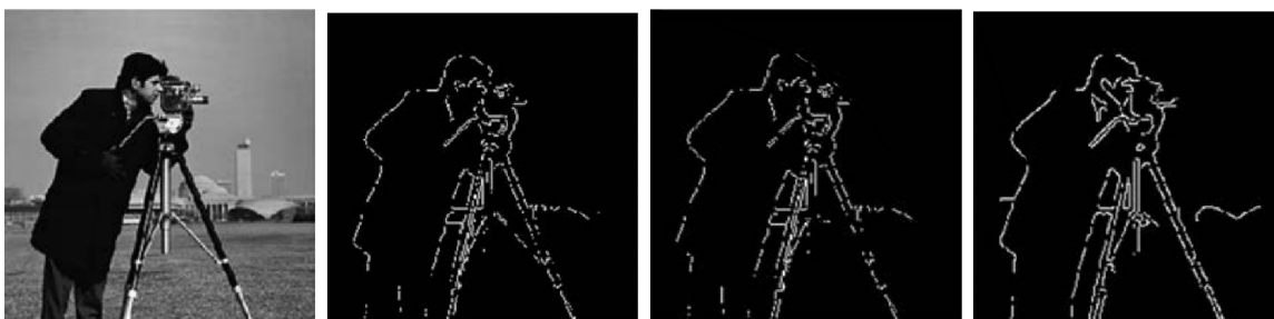
Obrázek 2.3: a) Originální snímek b) Sobel c) Prewitt d) Canny[14]
