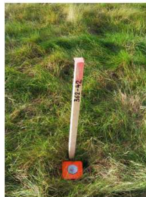
Obr. č. 17. Stabilizovaný hraniční bod plastovým mezníkem.
