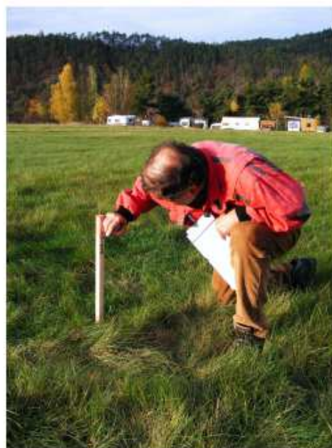
Obr. č.16. Vyznačení čísla bodu na dřevěný kolík.
