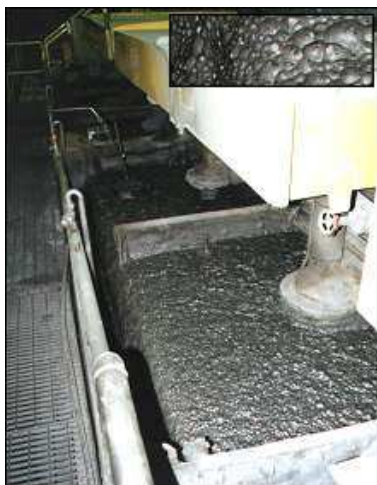
Obr.38: Flotační zařízení používané při úpravě zlatonosné rudy (vpravo nahoře detail pěny)
