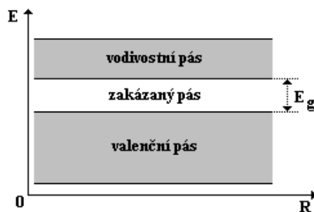
Obr.13: Rozdělení pásů podle energie ( R =odpor, E_g = energie zakázaného pásu, tj.rozdíl energií vodivostního a valenčního pásu)
