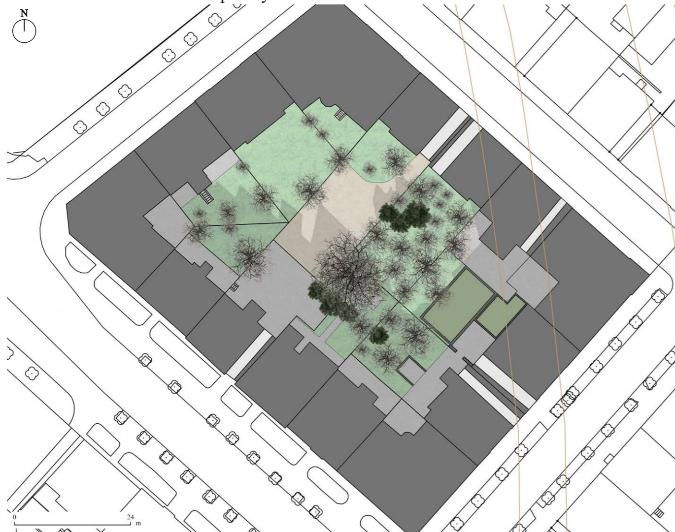
Obr. č. 153: mapa zastínění vnitrobloku č. 1 v zimě (čas: 12:00). Převzato z Ortofotomapy 2015, IPR Praha (upraveno).
