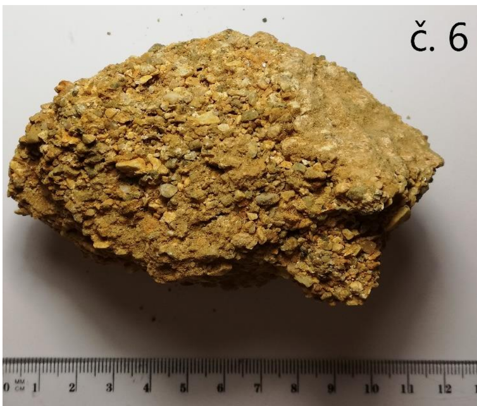
č. 6: Štěrkopísek (Rokytnice) – zrna nepřesahují velikost 2 cm, žlutavá barva. Miocén.
