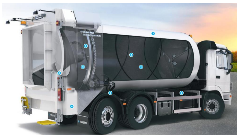
Obrázek 18 Schéma rotačního mechanismu u svozových automobilů
