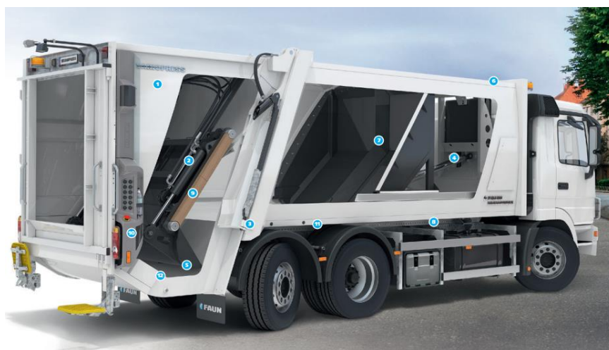
Obrázek 19 Schéma lineárního mechanismu u svozových automobilů
